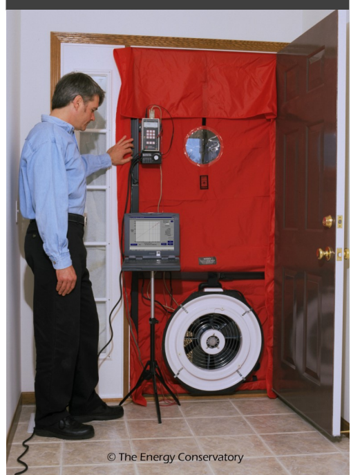
Blower Door Test
